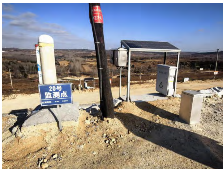
图 3.2-8 坝体表面位移监测、浸润线监测
