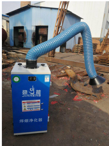
图 4-4 切割工序移动式焊烟净化器
