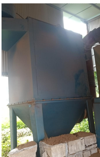
图 3-9 砂处理除尘器
